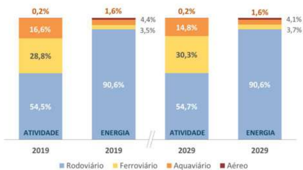
Gráfico 2-5 - Participação dos modos na atividade e demanda energética do transporte de cargas
